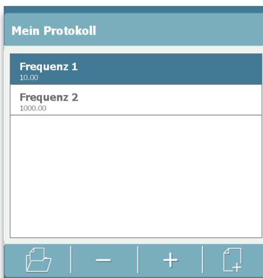
weitere Modulationsfrequenzen hinzufügen oder abwählen können. Die Frequenzen sind über die Tastatureingabe von 0 Hz (Dauerstrahl) auf bis zu 20.000 Hz einstellbar.
